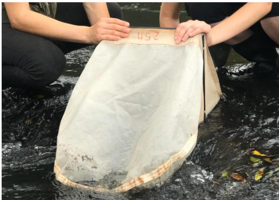
Figura 13 – Exemplo de aplicação do método Amostrador Suber na amostragem de invertebrados.
